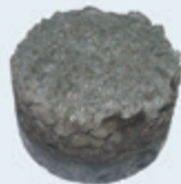
AC 11 D S mit 50/70 + SASOBIT Masseverlust: 4,9 %
