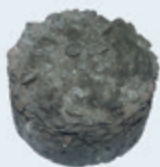
AC 11 D S mit 50/70 Masseverlust: 17,2 %
